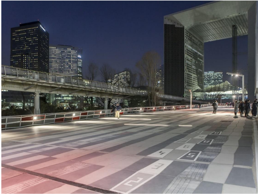
Figura.- Remodelación del paseo de La Defense en París. Entre otros elementos prefabricados de hormigón, losas de hormigón a medida para el pavimento con un contenido mínimo del 20% de árido reciclado
