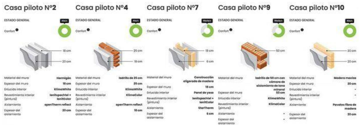
Figura.- La inercia térmica es independiente del valor de la transmitancia térmica del cerramiento. Fuente: Reto Kommerling [+]
