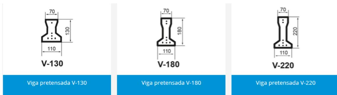
*Figura.- Modelos de viguetas pretensadas de una de las empresas asociadas. Los puntos dentro de la sección indican las posiciones de los alambres pretensados*
