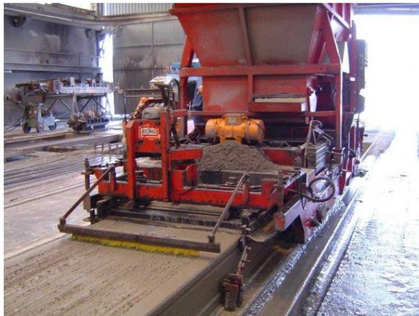
Estas máquinas avanzan a una velocidad aproximada de 1 metro / minuto, por lo que es imprescindible que el hormigón utilizado tenga una consistencia seca (relaciones agua / cemento muy bajas, de entre 0,15 y 0,20 aprox.) de forma que se evite el desmoronamiento de la placa recién moldeada.
