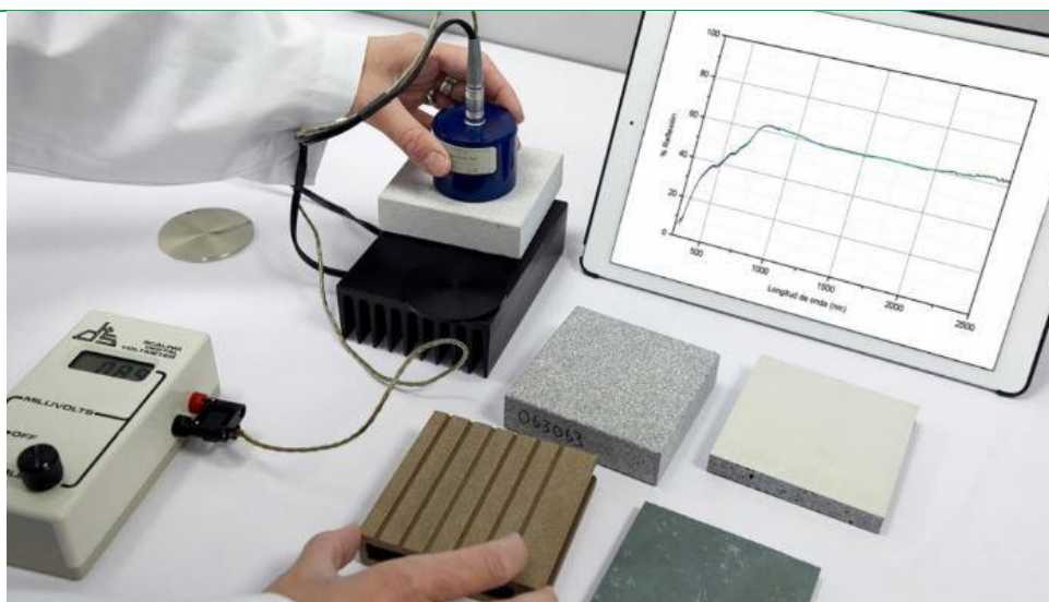
Figura.- Proceso de ensayo para determinación de SRI. Fuente [+]
