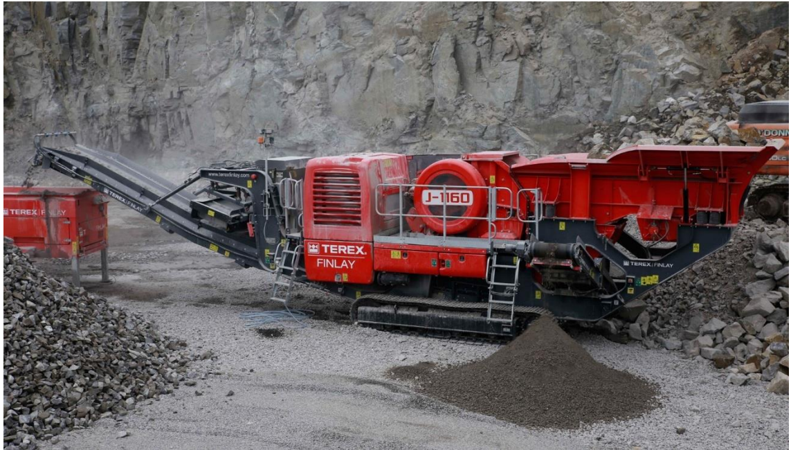
Figura.- Trituradora de mandíbulas primaria móvil. Fuente MYCSA
