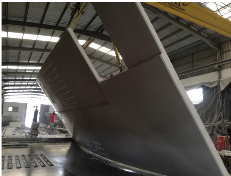
Figura.- Volteo de panel en fábrica, una vez ha alcanzado una resistencia mínima para poder ser manipulado
