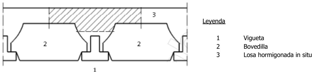
El canto total de la vigueta debe estar comprendido entre 60mm y 500 mm y la distancia entre ejes de viguetas no será mayor de 1 m.
