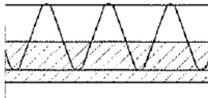
Prelosa con armadura básica electrosoldada en celosía
