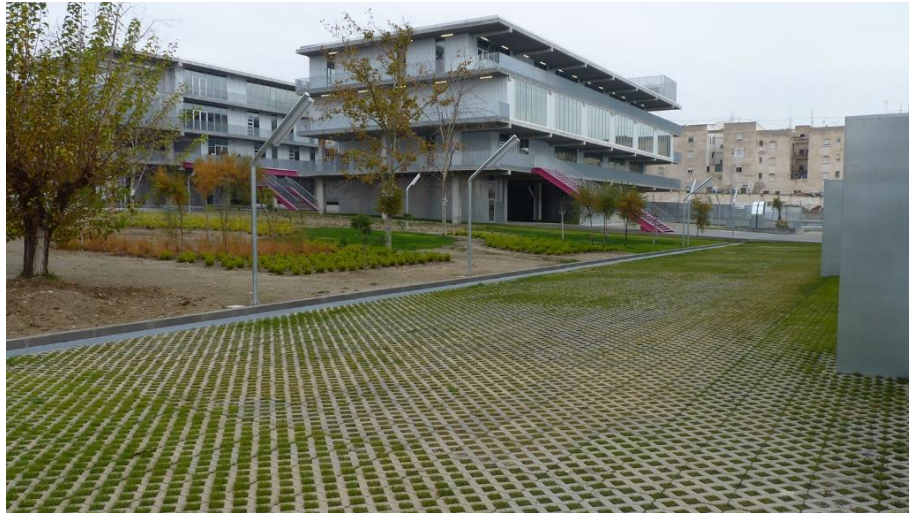
Figura.- Baldosa en celosía para el Campus Universitario en Lorca (Murcia). La nueva dimensión en el diseño de un paisaje mixto en el que se pueden introducir pequeñas zonas verdes en sus celdas, obteniéndose una fusión perfecta entre la naturaleza y los elementos prefabricados de hormigón
