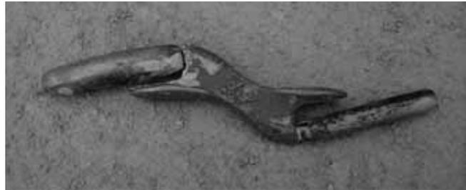
Ilustración 189. Herramientas de repasado de juntas con extremos para diferentes espesores de junta.
