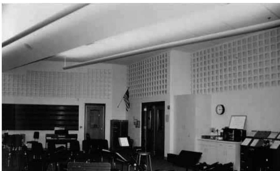
Ilustración 204. Interior de una sala de música con bloque de acondicionamiento acústico Soundcell.
