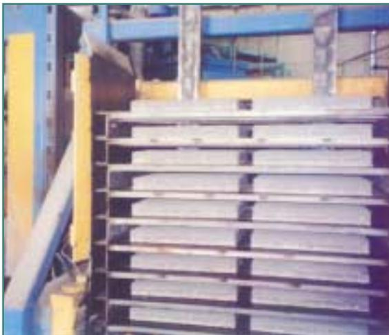
En el sistema de vibrocompresión se realiza una vibración que se complementa con un pequeño prensado del material.
