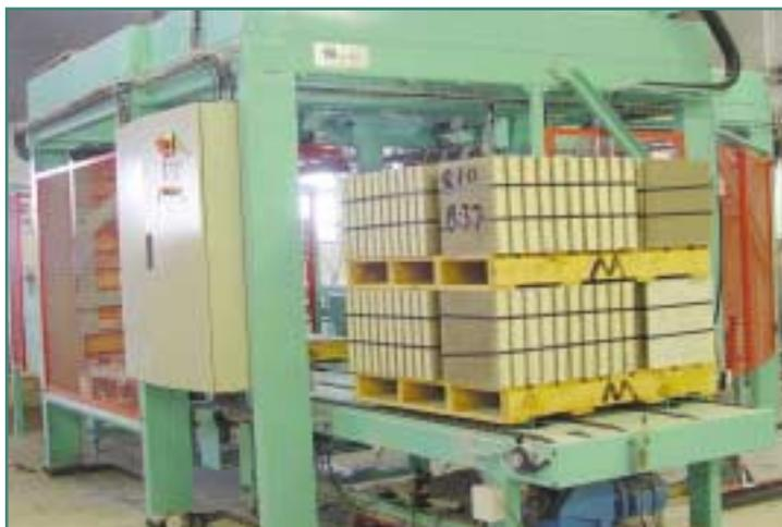
Todo el proceso de embalaje de las baldosas **TECNOPAVIMENTO** se realiza una vez finalizado el curado y los tratamientos secundarios. Durante este proceso se realiza un control visual individual de la producción. El paletizado puede ser manual o automático. Cada fabricante tiene su propio sistema de paletizado en función del tipo de maquinaria utilizada.
