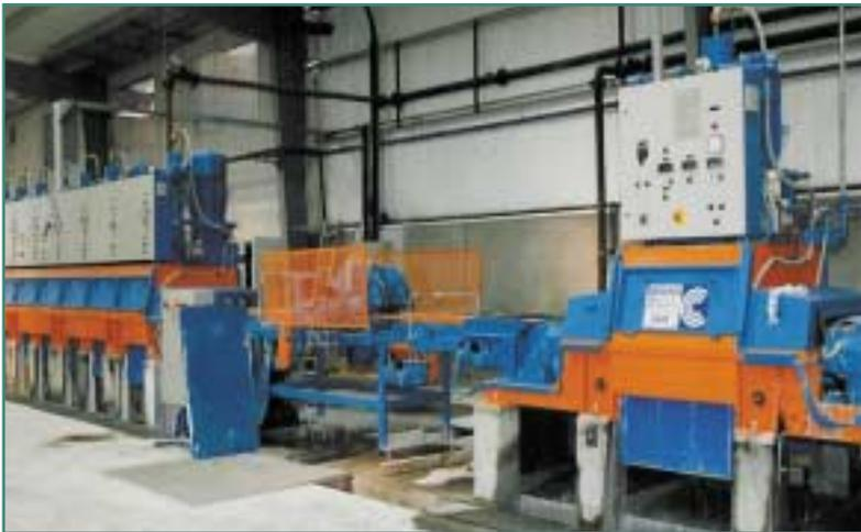
La pulidora consta de diversos cabezales en los cuales se montan distintas muelas abrasivas con diferentes tamaños de granos, que van puliendo la pieza de forma gradual, produciéndose así el desbastado, pulido y abrillantado.
