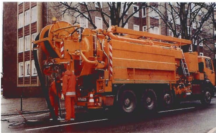
*Figura 6.2.a Camión de succión e impulsión*
