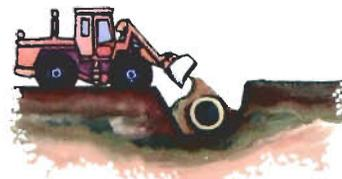
El material de relleno, que deberá ser seleccionado y exento de piedras, no deberá ser empujado a la zanja o lanzado directamente sobre el tubo a más de 30 cm sobre la generatriz superior. Se deberá colocar de modo que no desplace ni dañe al tubo instalado.
