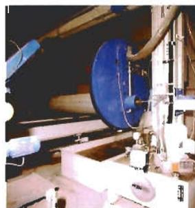
*Máquina de ensayo de estanquidad*
