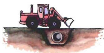
No se debe trabajar con maquinaria pesada sobre el tubo hasta que el relleno esté adecuadamente colocado y existan al menos, 80 cm de cobertura de tierras sobre la clave (excepto cuando el tubo esté dimensionado para ello).
