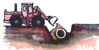
El material de relleno deberá ser compactable y no deberá contener grandes piedras, guijarros, terrones helados y otros materiales desaconsejables. El relleno deberá ser colocado y compactado en capas según las especificaciones.
