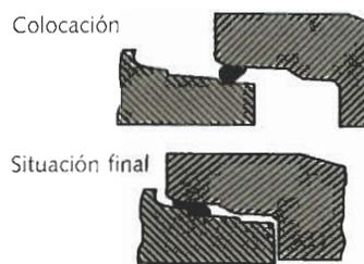
Figura 5.5.5.3.c Ejemplo de junta rodante
