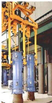
*Robot para la extracción de la arandela soporte*
