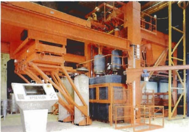
En consecuencia se están empezando a adaptar a los últimos modelos de prensa de vibrocompresión un dispositivo unido al núcleo que actúa como los cabezales de las máquinas de las prensas radiales, permitiendo obtener de esta forma tubos de igual longitud. También se están desarrollando prototipos de prensa radial que incorporan el núcleo de vibración.
