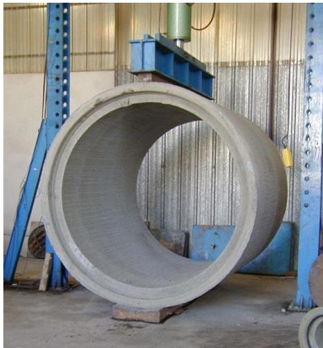
Figura 4: Ensayo de tres aristas en un tubo de hormigón armado.
