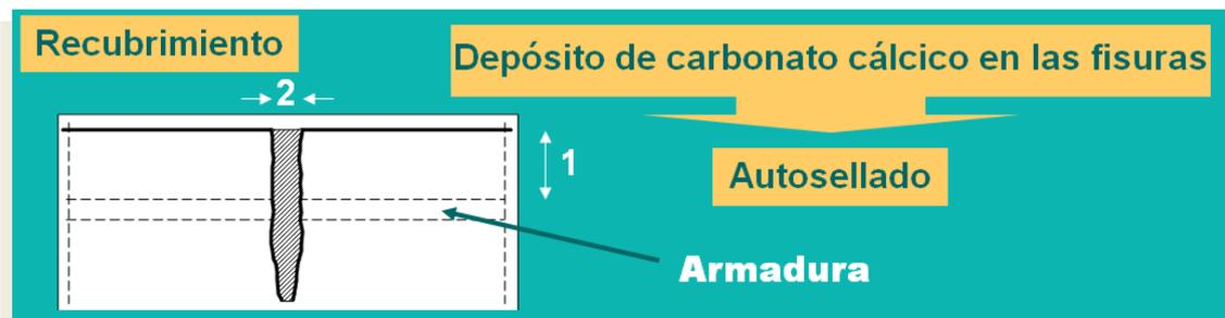
Figura 8: Autosellado de las fisuras en el hormigón.
