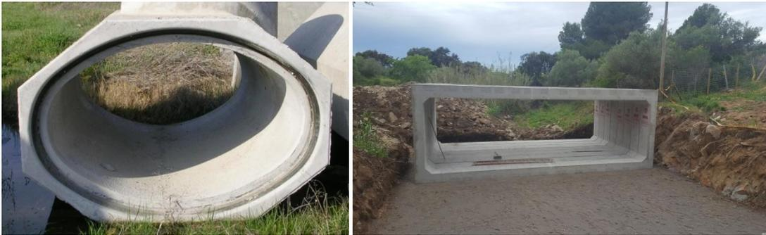
Figura 5: Soluciones para obras con altura escasa.
