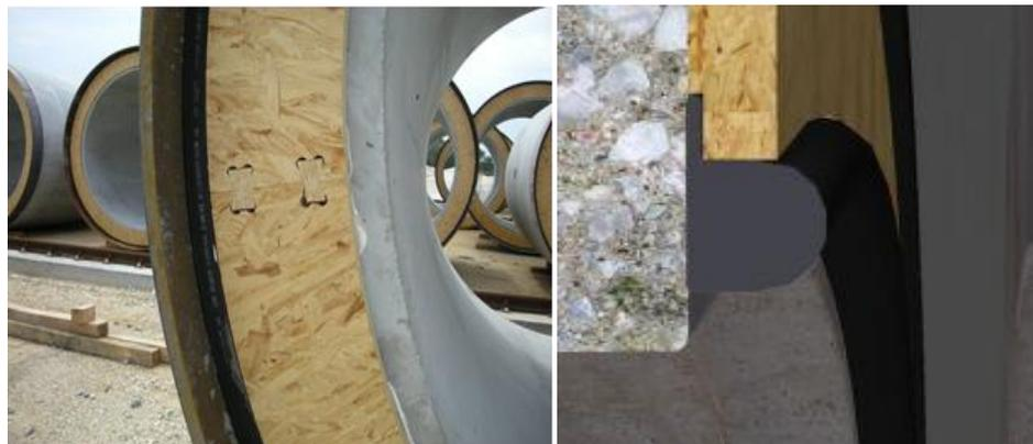
Figura 11: Sufrideras en un tubo de hormigón armado.
