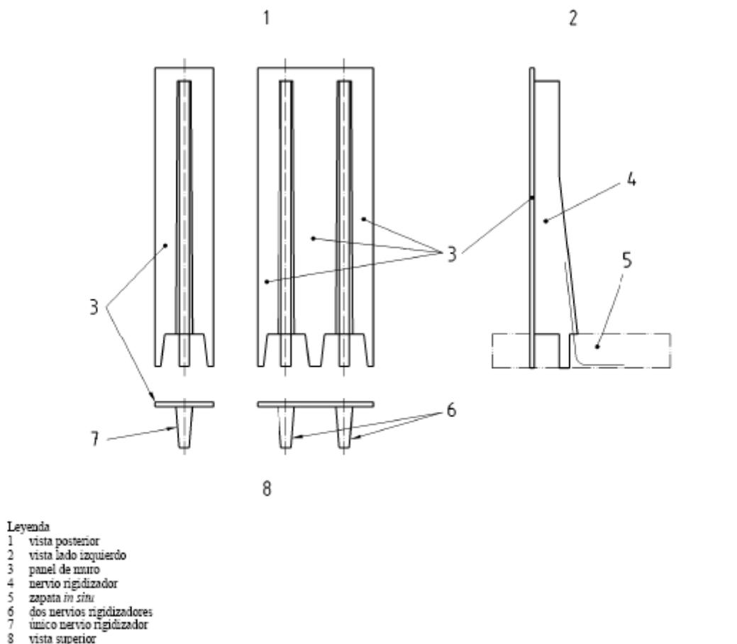
Figura B.1 – Elementos prefabricados con zapata para muros en ménsula y estribos de puentes (por ejemplo)
