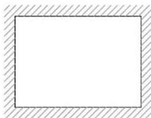
Para facilitar el procedimiento de prorrateo de momentos en la fábrica se ha condensado en una serie de tablas que establecen la distribución de momentos según las dos direcciones determinadas por la configuración básica de toda fábrica tradicional formada por tendeles horizontales y su relación de resistencia y la relación de los lados de la placa, siempre rectangular.
