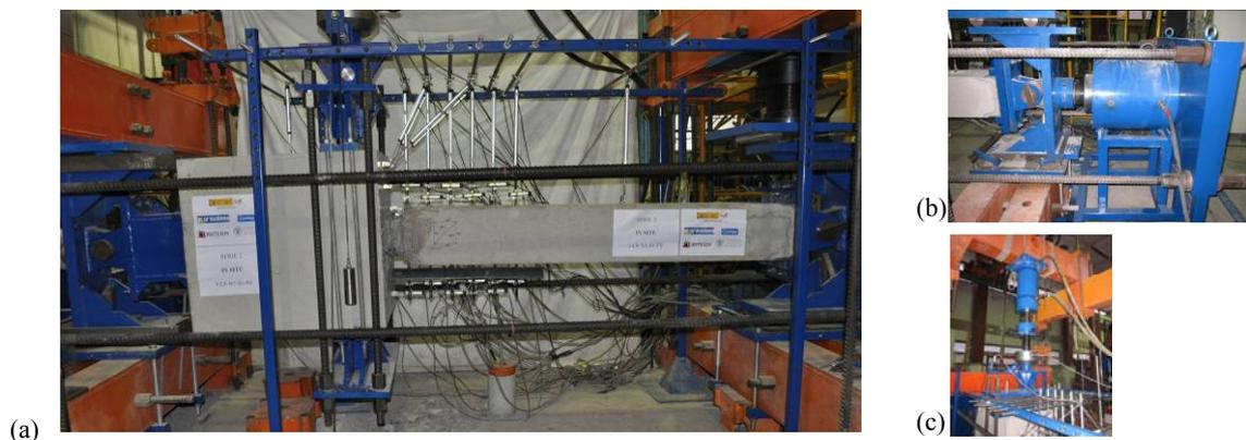
Figura 4. Pórtico de ensayo y probeta ensayada.
