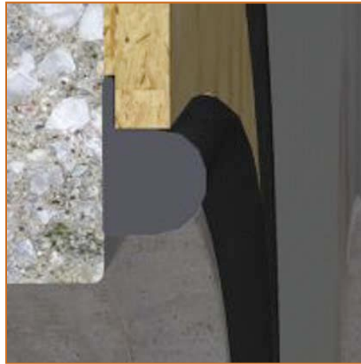
Figura 7. Junta iglú y sufridera de aglomerado
