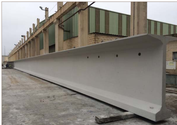
■ Figura 5. Viga doble T de 55 m de longitud para nuevo edificio Campofrío en Burgos. Supone un ejemplo de los avances tecnológicos en la prefabricación, en cuanto a diseño y mejora de materiales. Cortesía de Precon.
