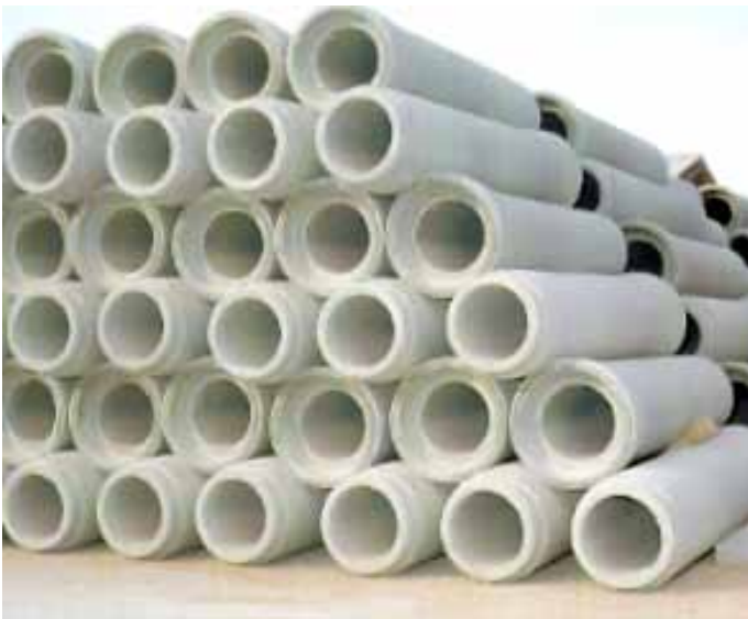
FIGURA 30 - ACOPIO EN 6 ALTURAS DE TUBOS PREFABRICADOS
