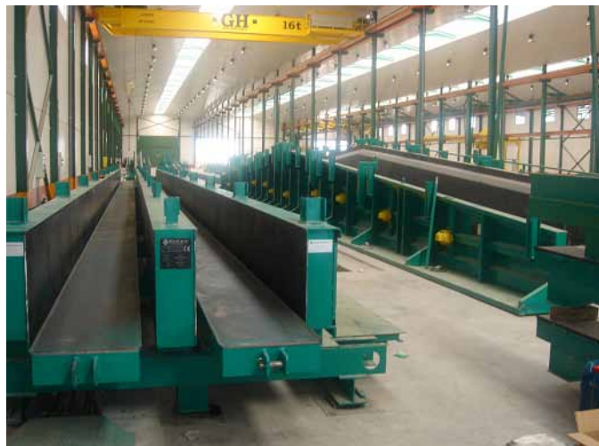
FIGURA 8 - DIFERENTES MOLDES PARA FABRICAR ELEMENTOS PREFABRICADOS DE HORMIGÓN
