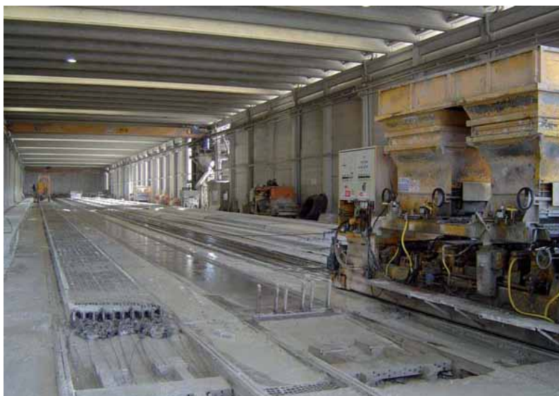
FIGURA 58 - FABRICACIÓN DE PLACAS ALVEOLARES EN PLANTA.
