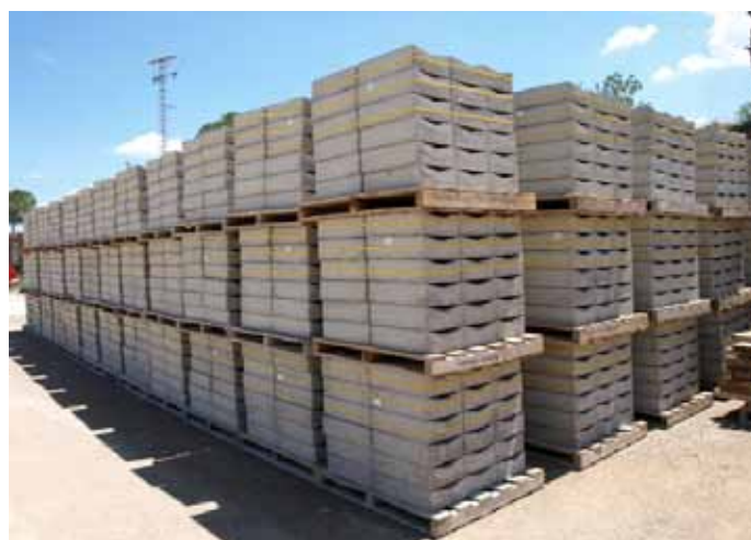
FIGURA X12 - ALMACENAMIENTO DE PREFABRICADOS DE HORMIGÓN: PALETIZADOS Y MEDIANTE APILAMIENTO
