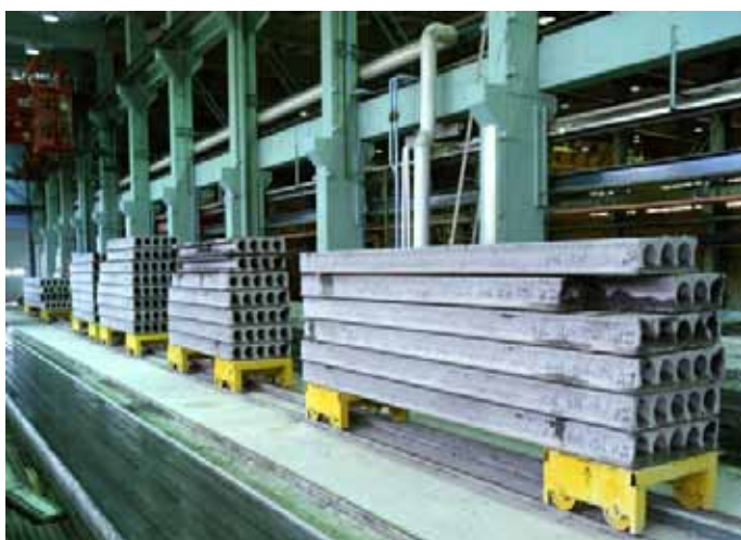
FIGURA 11 - VAGONES Y PUENTE GRÚA PARA EL TRANSPORTE Y MANIPULACIÓN DE PIEZAS
